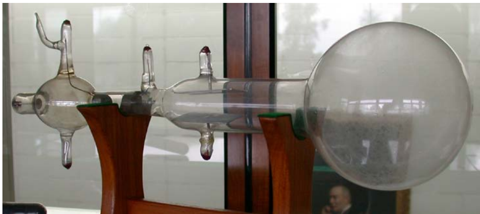
Tubo original de raios catódicos empregado por Thomson para a determinação da relação carga/massa do elétron
