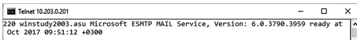
Рисунок 12.2 – Подключение к серверу SMTP с помощью команды TELNET
