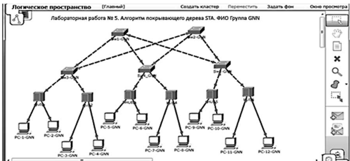
Рисунок 5.2 – Создание избыточных резервных связей
