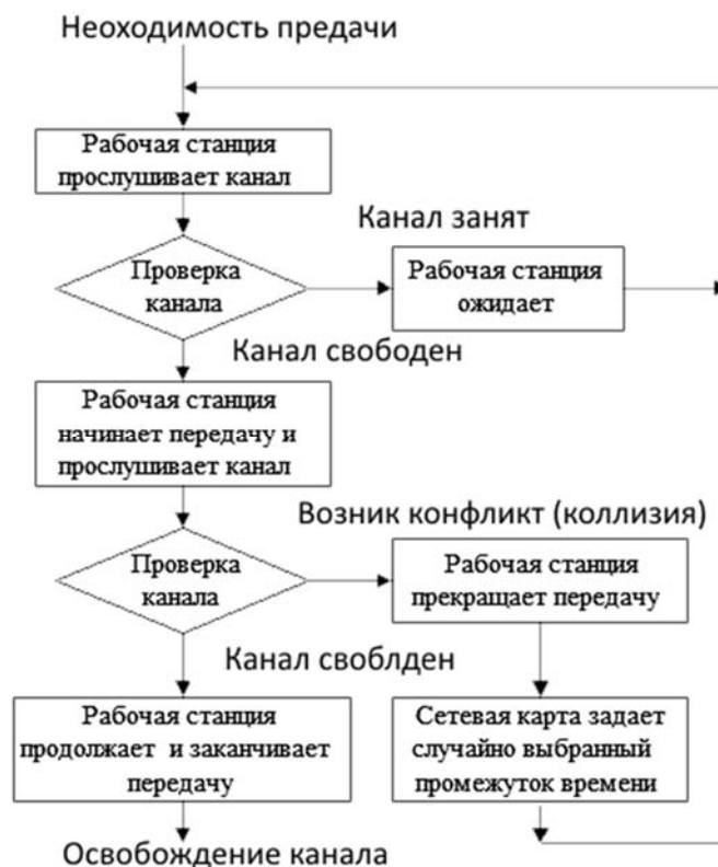
Рисунок 3.1 – Упрощенный алгоритм метода доступа CSMA/CD
