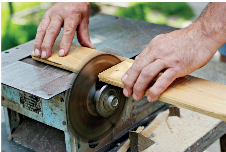
Figura 4.6 | Falta de proteção nas mãos para o uso de serra de mesa
