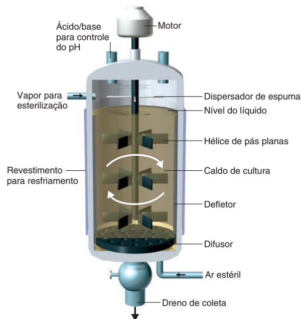
Figura 28.7 Secção de um biorreator de agitação contínua para fermentações industriais.
