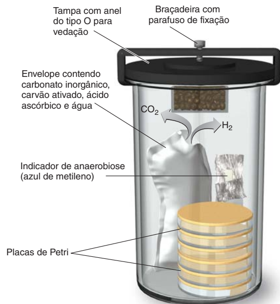
Figura 6.6 Uma jarra para cultivar bactérias anaeróbias em placas de Petri. Quando água é adicionada à embalagem química contendo bicarbonato de sódio e boridreto de sódio, hidrogênio e dióxido de carbono são gerados. O catalisador de paládio está localizado em uma câmara separada, que também pode ser incorporada à embalagem química, e na sua superfície ocorrerá a reação entre o hidrogênio e o oxigênio atmosférico do interior da jarra, que, combinados, formarão água. O oxigênio é, assim, removido. Na jarra há também um indicador de anaerobiose contendo azul de metileno, que tem a coloração azul quando oxidado, tornando-se incolor quando o oxigênio é removido (como mostrado aqui).
