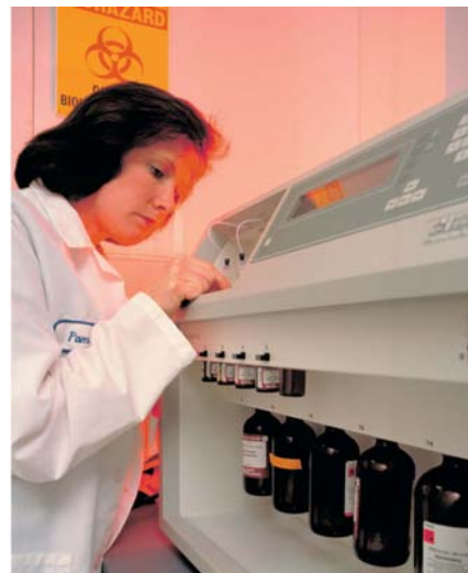
Figura 9.10 Uma máquina de síntese de DNA. Sequências curtas de DNA podem ser sintetizadas por aparelhos como este.
