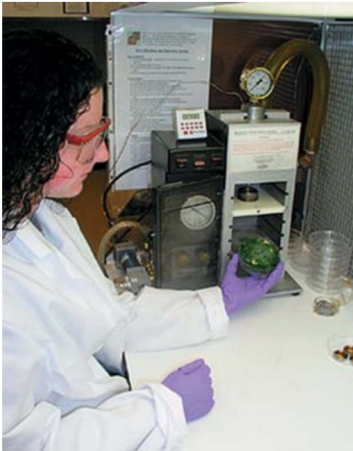
Figura 9.6 Pistola gênica, que pode ser utilizada para inserir “projéteis” revestidos de DNA em uma célula.
