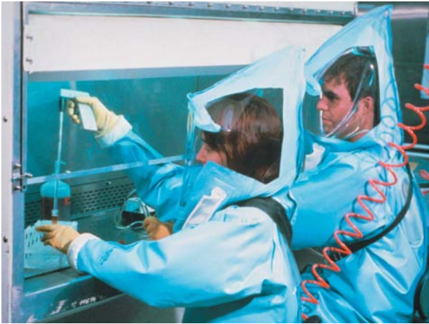
Figura 6.8 Técnicos em um laboratório de biossegurança de nível (BSL-4). Os profissionais trabalhando em instalações BSL-4 vestem uma "roupa espacial", conectada a um fornecimento de ar externo. A pressão do ar na roupa é maior do que a atmosférica, o que impede a entrada de micróbios.
