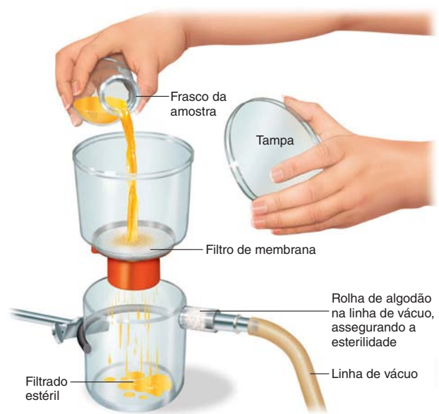
Figura 7.4 Esterilização com filtro de unidade plástica descartável, pré-esterilizada. A amostra é colocada na câmara superior e forçada através do filtro de membrana pelo vácuo, para a câmara inferior. Os poros do filtro de membrana são menores que as bactérias, e, assim, elas são retidas no filtro. A amostra esterilizada pode, então, ser decantada na câmara inferior. Um equipamento similar com discos de filtro removíveis é utilizado para contar as bactérias em amostras (ver Figura 6.18).
