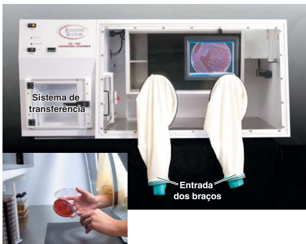
Figura 6.7 Uma câmara anaeróbia. Os materiais são introduzidos pelas pequenas portas do sistema de transferência da câmara, à esquerda. O operador trabalha pela entrada dos braços utilizando luvas herméticas. As luvas herméticas se estendem para o interior da capela quando em uso. Esta unidade também tem uma câmera interna e um monitor.
