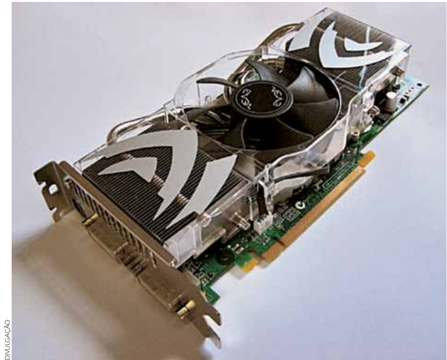
Figura 88 Placa de vídeo MSI Force 9600GT com 2 Gb de memória GDDR3.
