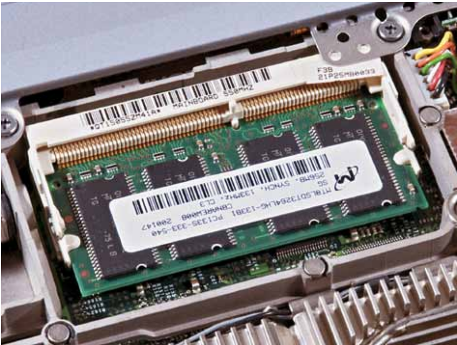
Figura 37 Slot de memória de uma placa-mãe de laptop.
