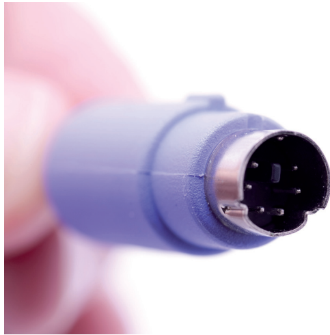
Figura 3.6: Conector do teclado
