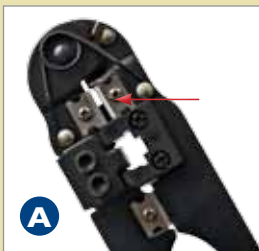
Identificando as lâminas de decapagem do cabo.
